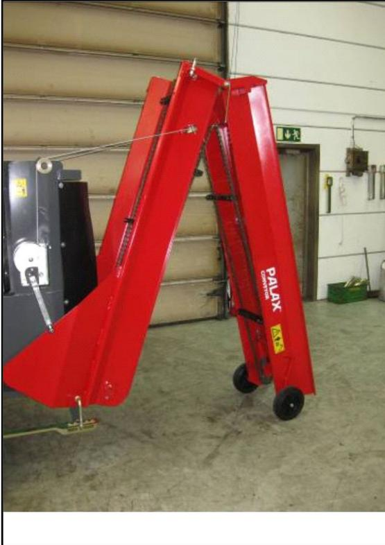
1. Ziehen Sie den Förderer nach unten, so dass er auf den Windenseilen und dem Vorderrad aufliegt. Entfernen Sie den Förderkettenhalter unterhalb des Förderers.
