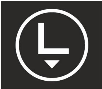
Hebepunkt der Maschine
