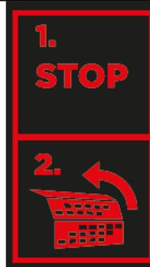
Das Sägeblatt muss sich in der oberen Stellung befinden, damit das Schutzgitter der Spaltrinne geöffnet werden kann.
