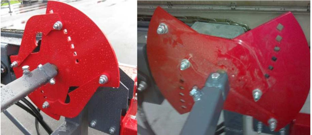
Abb. 3. Einstellung der Zuführscheibe für dünnes und dickes Holz
