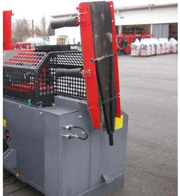
Abb. 5. Beispiel für die Schnellkupplungen der Maschine
