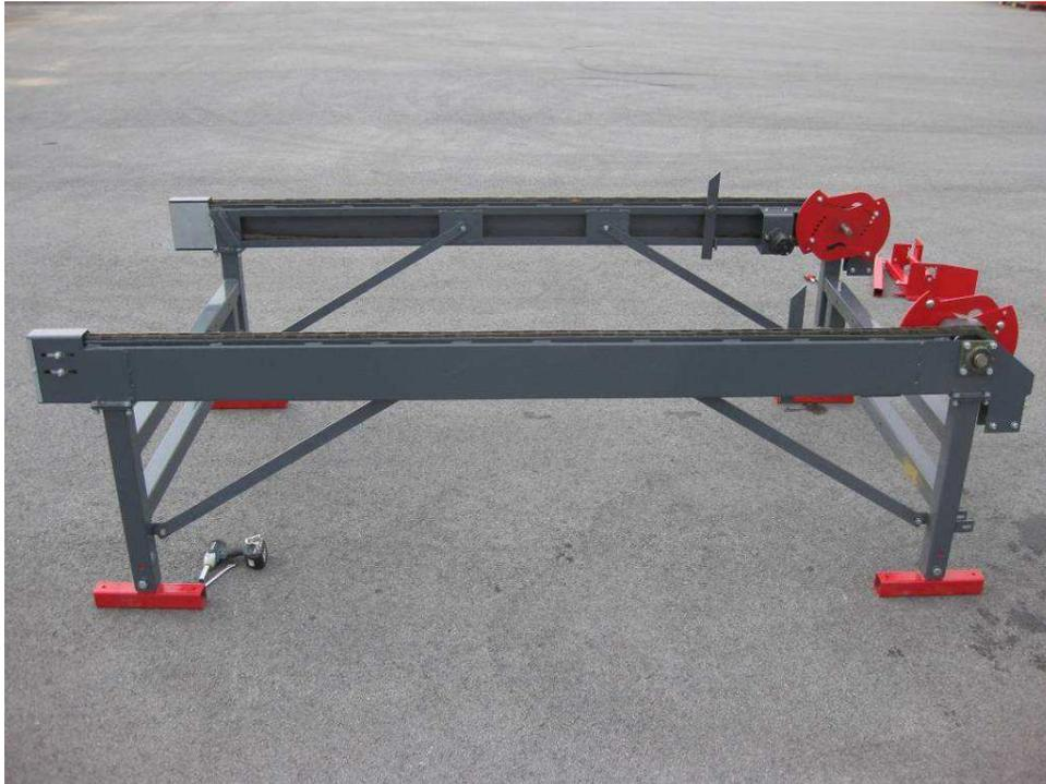
Heben Sie die Kettenträger auf die Rahmenteile, die Antriebsenden in Richtung der doppelten Befestigungsfahnen. Zwischen den Kettenträgern wird eine Antriebswelle befestigt, um die Drehgeschwindigkeit anzugleichen. Beachten Sie, dass sich beide Zuführscheiben in der gleichen Stellung befinden müssen.
