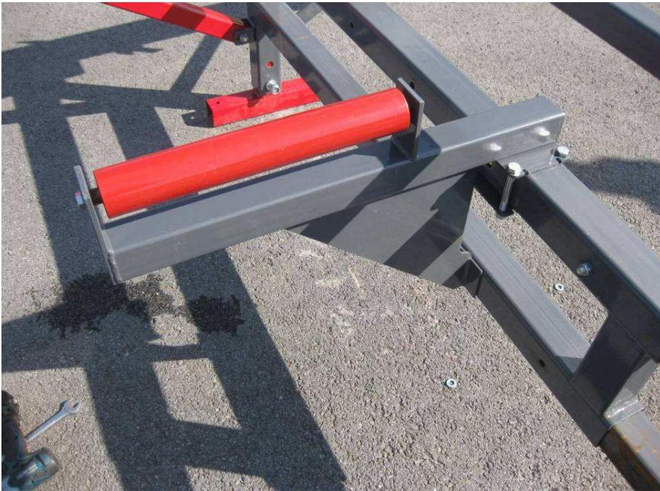
Die Zusatzrolle wird in der Mitte zwischen Rolle und Motor befestigt.
