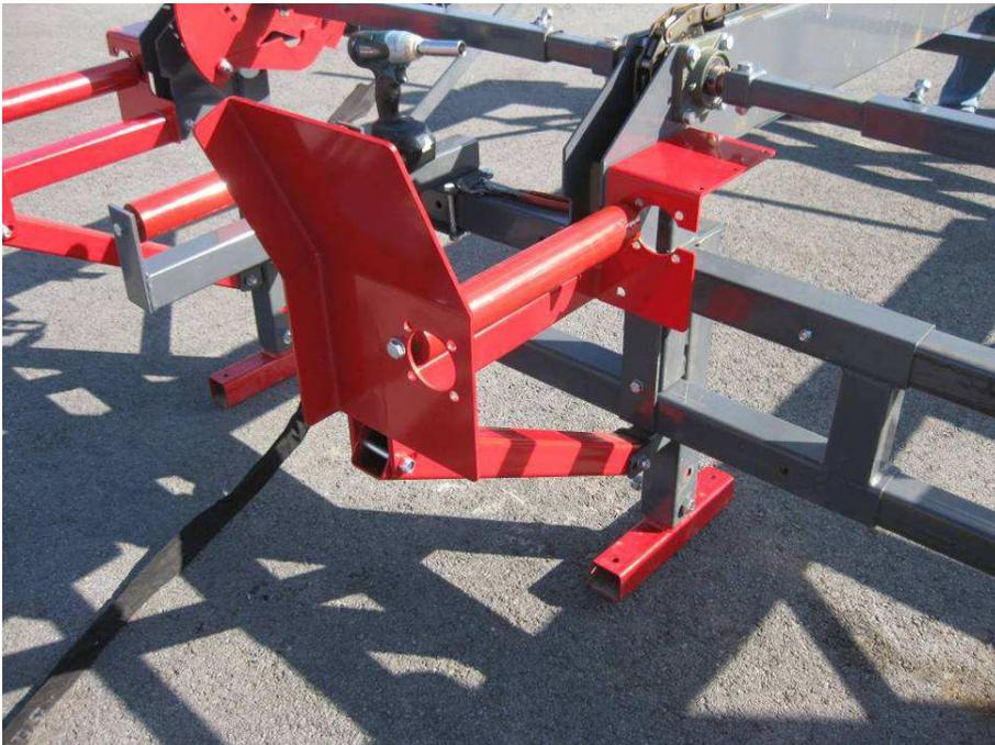
Die Zusatzrolle wird entfernt und an ihrer Stelle die/der im Zusatzträgerpaket mitgelieferte Rolle/Motor befestigt.
