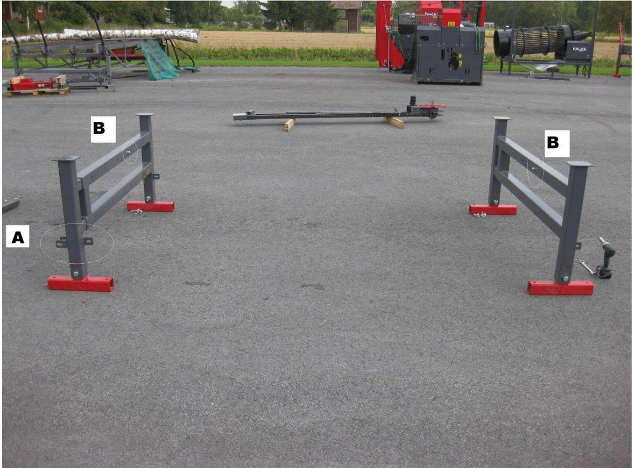
Drehen Sie die Rahmenteile um, die FüÙe nach unten, die einfachen Befestigungsfahnen nach innen (A). Die Breite des Bockes kann zwischen 1,7 m – 2,3 m eingestellt werden (B).
