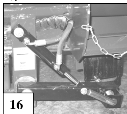
Bilde 16. Hydraulisk høydeinnstilling av kløyveveggen
