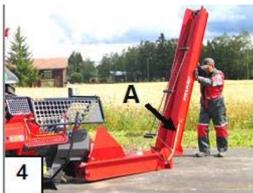
Bilde 4. Utretting av transportøren 1/2
