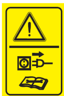
Koble ut strømtilførselen til maskinen før service
