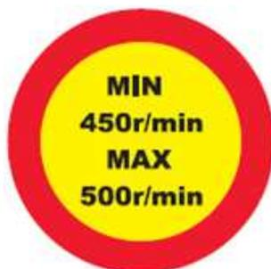
Drehzahl der Zapfwelle
