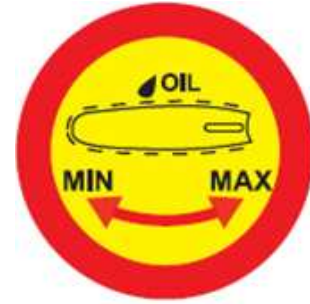
Ajuste del caudal de aceite de la sierra de cadena
