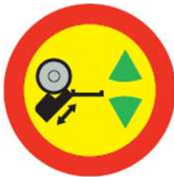
Colocar el tronco sobre los rodillos de alimentación utilizando la plataforma de troncos hidráulica
