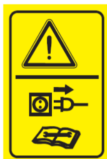
Koppla ur strömtillförseln till maskinen före servicen
