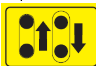
Att stanna maskinen genom att lösa på kilremmarna
