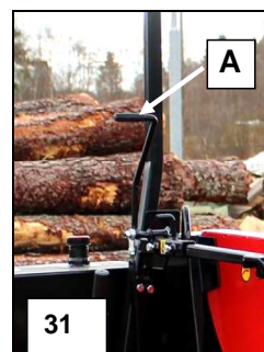
Kuva 31. Kiilahihnojen kiristys ja löystytys
