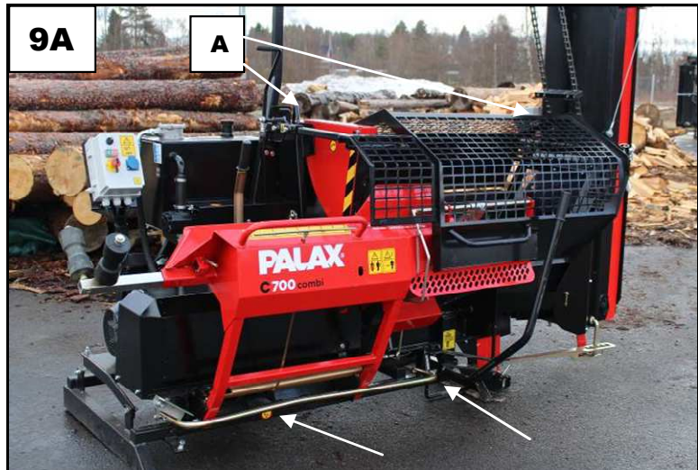
Kuva 9A. Koneen nostokohdat
