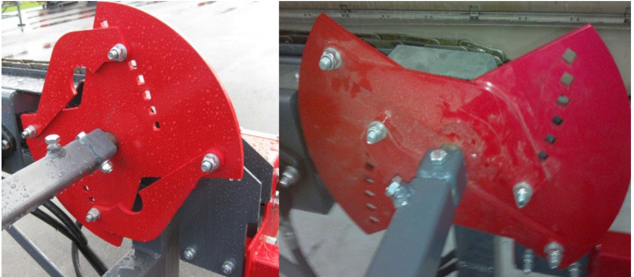
Kuva 3. Syöttökierok kuvattuna pienelle ja isolle puulle säädettyinä
