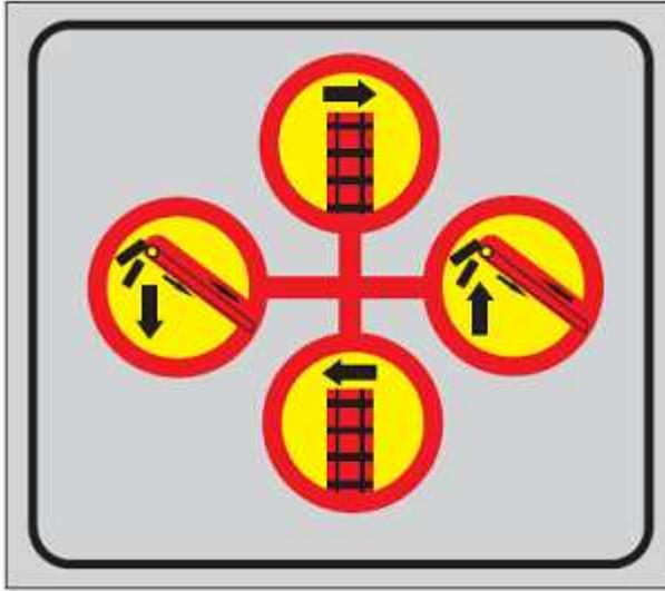
Réglage latéral du convoyeur de décharge Réglage en hauteur du convoyeur de décharge
