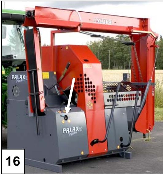
**N.B. : Utilisez uniquement l'option à haute vitesse pour les arbres minces que vous êtes sûrs de pouvoir fendre ainsi. Si la machine manque de puissance de manière répétée, la transmission sera soumise à une contrainte superflue et l'huile chauffera.**
