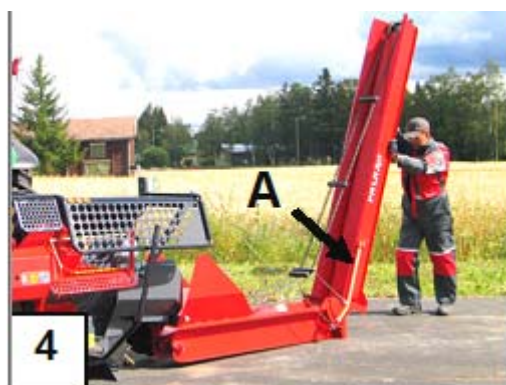
Fig. 4. Déploiement du convoyeur 1/2
