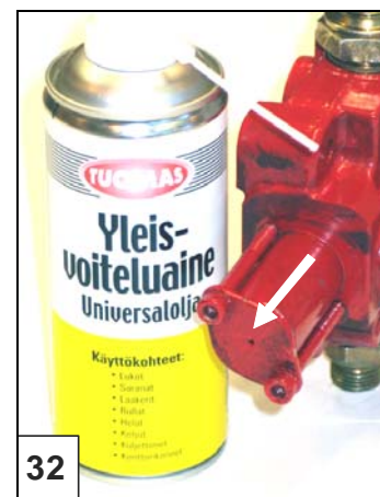
Fig. 32. Côté détente de la soupape
