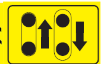
Arrêt de la machine par desserrage des courroies trapézoïdales
