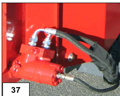
Fig. 37 Transmission du convoyeur
