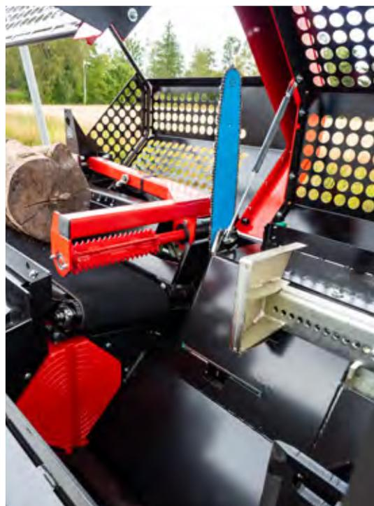
油圧駆動ローラーを備えた割材クランプは、効率的な割材の送り出しを実現します。
