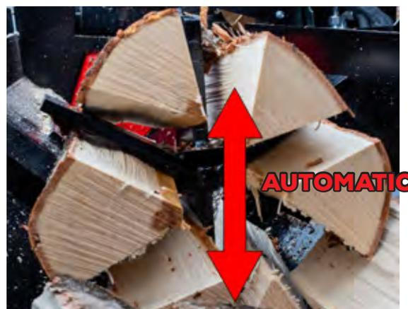
X-Aimは、割材の中央部で最適な高さに自動でスプリッティングウェッジを調整します。
