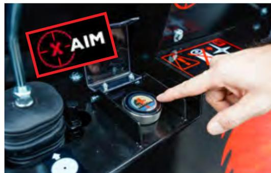
X-Aim は自動的に分割ウェッジを最適な高さに調整します。
