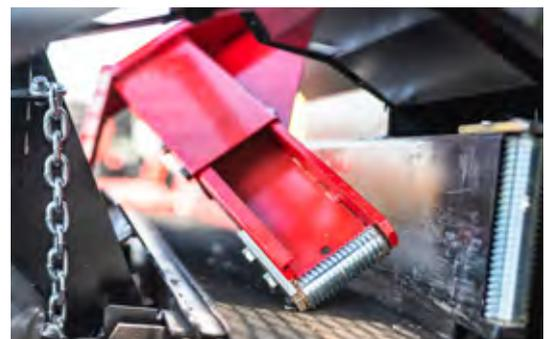
ProとPro+モデルの場合、油圧式ログクランプは自動的に動作し、ログコントロールが向上。
