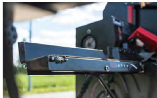
インフィードコンベアのしっかりとしたバックボードが丸太の供給を容易にします。
