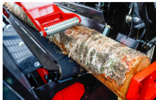
Hydraulické upínání kulatiny je automatizované a zlepšuje ovládání kulatiny.
