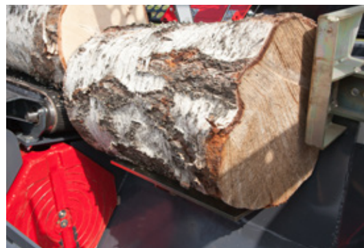
Padací deska navádí dřevo přímo do štípacího skluzu.
