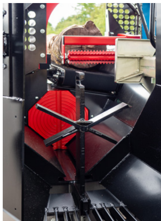
Výměna hydraulicky nastavitelného štípacího klínu je velmi snadná.
