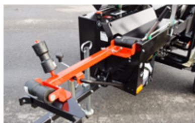
Robustní nástavec stolu usnadňuje podávání kulatiny do řezu.
