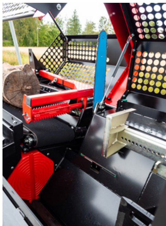
Upínání kulatiny s hydraulickým hnacím válečkem zajišťuje efektivní podávání kulatiny.
