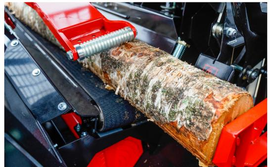
Die hydraulische Holzklammer arbeitet automatisch und verbessert die Holzsteuerung.
