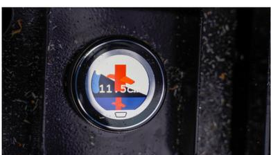
Mit X-Aim wird die Höhenanpassung des Spaltnessers automatisiert und führt trotz des unterschiedlichen Durchmessers des Holzes zu gleichbleibend hochwertigem Brennholz.
