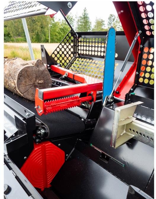
Die Holzklammer mit hydraulischer Antriebsrolle sorgt für eine effiziente Holzzufuhr.
