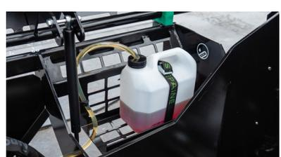
Die Menge an Kettenöl ist für den Benutzer jederzeit sichtbar und leicht zu befüllen.
