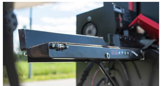
Eine solide Rückwand des Zufuhrförderers erleichtert die Holzzufuhr.
