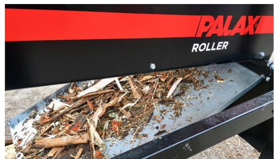
Der Palax Roller entfernt Holzreste. Brennholz kann mit dem Roller mithilfe eines Frontladers problemlos erneut gesiebt werden.
