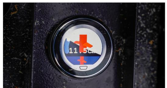
Mit X-Aim wird die Höhenanpassung des Spaltmessers automatisiert und führt trotz des unterschiedlichen Durchmessers des Holzes zu gleichbleibend hochwertigem Brennholz.
