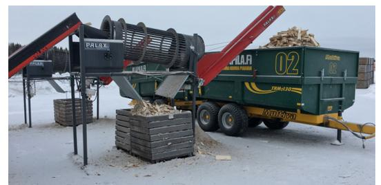
Palax Cleaner ermöglicht eine effektive Entfernung von Schmutz direkt nach dem Schneiden und Spalten.
