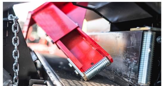
Pro und Pro + Modelle: Die hydraulische Holzklemme arbeitet automatisch und verbessert die Holzsteuerung.
