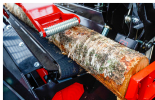
Automaatselt toimiv hüdrauliline palgi fiksaator hoiab palki paremini kontrolli all
