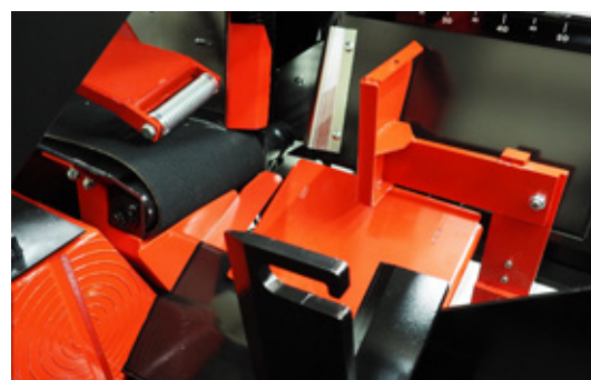
Alusplaat suunab puidu otse lõhkumisrenni.
