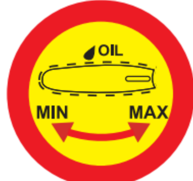
Justering av oljemengden til sagkjeden
