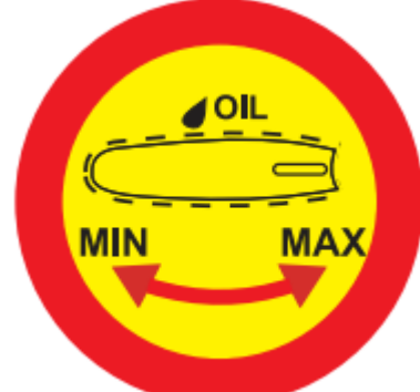
Justering av oljemängden till sågkedja
