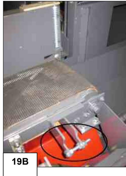
An der Klinge des Zuführbands befindet sich eine Stellschraube (19 B), mit welcher die Lauflinie des Bandes geändert und das Band ausgerichtet werden kann.
