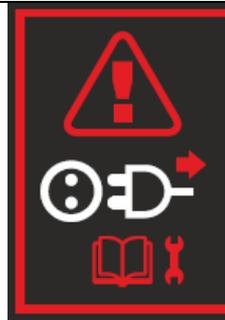
Desconectar la fuente de alimentación de la máquina antes de realizar cualquier operación de mantenimiento
