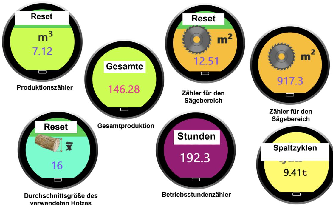
Die Betriebszähler mit Reset-Knopf können durch Antippen des oberen Bildschirmrandes zurückgesetzt werden. Die Produktivitätsdaten werden nach jeweils 30 Minuten Betrieb und bei normalem Stillstand der Maschine gespeichert. Wird die Maschine per Not-Aus-Taste gestoppt, werden die Daten nicht gespeichert.
