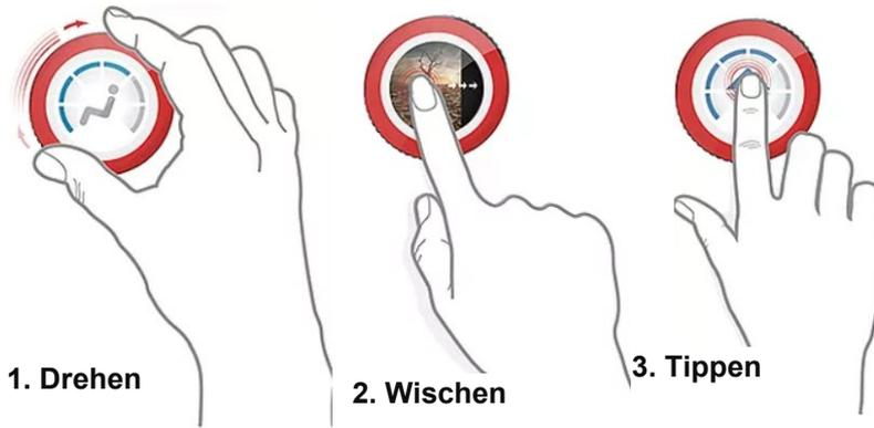
Die **Drehfunktion** dient zur manuellen Einstellung der Keilposition und zur Einstellung der Betriebsparameter des Systems.
