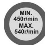
Geschwindigkeit der Zapfwelle
