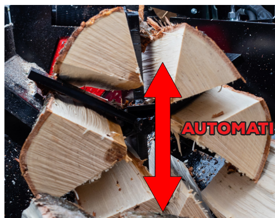
Tillbehöret X-Aim justerar automatiskt klyvyxan till optimal höjd vid mitten av stocken.
