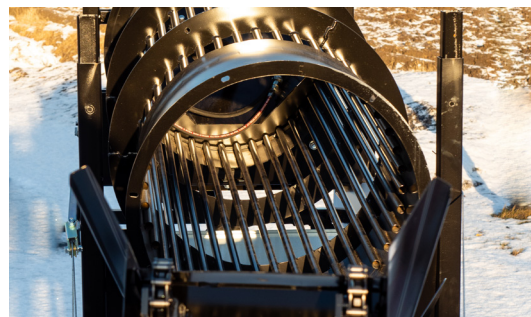
Palax Cleanerissä on pyörivä roskarumpu.
