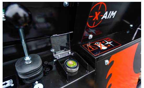
X-Aimin kosketusnäytön avulla käyttäjä saa reaaliaikaista dataa työn tuottavuudesta.
