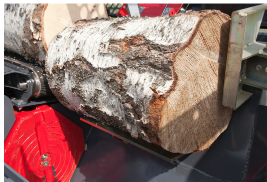
Puun pudotuspelti ohjaa puun suorassa halkaisukouruun.
