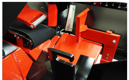
Puun pudotuspelti ohjaa puun suorassa halkaisukouruun
