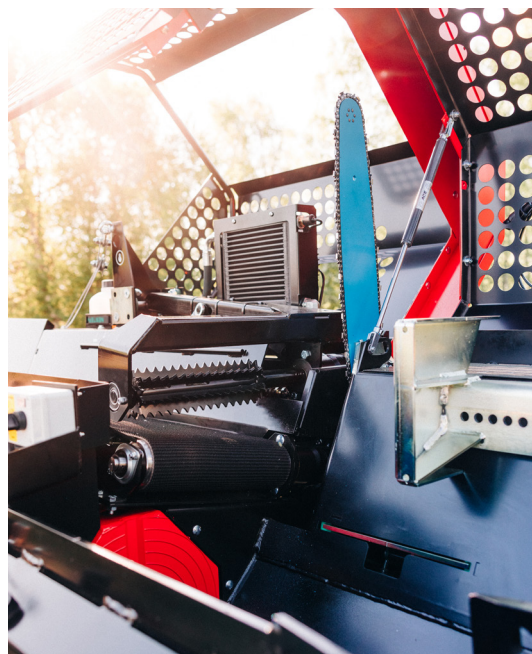
Hydraulisella vetorullalla varustettu puun painin takaa tehokkaan puun syötön.
